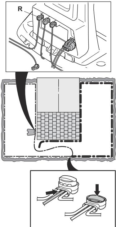
Если индикаторная лампа теперь мигает желтым светом, это означает, что обрыв находится где-то на участке провода между отсоединенными концами и местом, где подсоединен новый провод (жирная черная линия ниже). В этом случае переместите соединение нового кабеля ближе к отсоединеному концу (примерно посередине того участка, где, на ваш взгляд, произошел разрыв) и проверьте снова, горит ли контрольная лампа зеленым светом.
