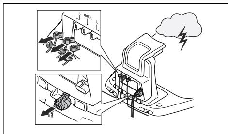
Для снижения риска повреждения электрических компонентов изделия и зарядной станции мы рекомендуем отсоединить все подключенные к зарядной станции элементы (источник питания, ограничительный и направляющий провода), если ожидается гроза.
