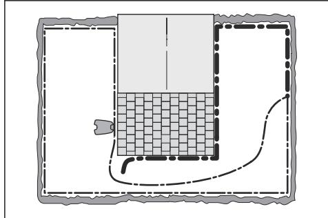
Продолжайте поиск места обрыва, пока не останется один короткий участок, на котором индикаторная лампа мигает синим светом, а не горит ровным зеленым светом. Затем следуйте инструкциям, приведенным в шаге 5 ниже.
