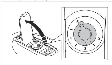
3. Поверните ручку регулировки высоты стрижки, чтобы выбрать высоту стрижки.
