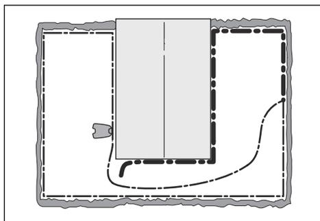
Продолжайте поиск места обрыва, пока не останется один короткий участок, на котором индикаторная лампа мигает синим светом, а не горит ровным зеленым светом. Затем следуйте инструкциям, приведенным в шаге 5 ниже.
