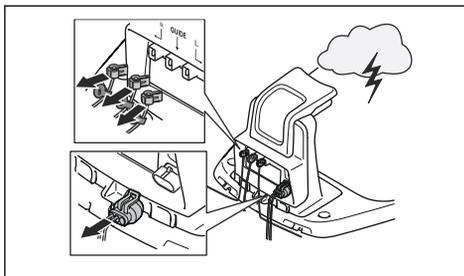
Для снижения риска повреждения электрических компонентов изделия и зарядной станции мы рекомендуем отсоединить все подключенные к зарядной станции элементы (источник питания, ограничительный и направляющий провода), если ожидается гроза.
