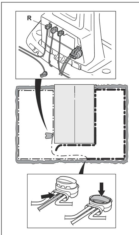
Если индикаторная лампа теперь мигает желтым светом, это означает, что обрыв находится где-то на участке провода между отсоединенным концом и местом, где подсоединен новый провод (жирная черная линия ниже). В этом случае переместите соединение нового кабеля ближе к отсоединенному концу (примерно посередине того участка, где, на ваш взгляд, произошел разрыв) и проверьте снова, горит ли индикаторная лампа зеленым светом.
