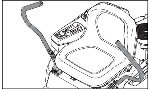
O travão de estacionamento está integrado nas alavancas de controlo da direção. Mova **ambas** as alavancas para fora face à posição neutra para acionar o travão de estacionamento.
