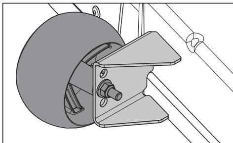
**INFORMAÇÕES IMPORTANTES** Ajuste os roletes antiarranhões com o cortador em uma superfície plana e nivelada. Para evitar danos à plataforma, os roletes antiarranhões não devem ser ajustados para apoiar a plataforma.
