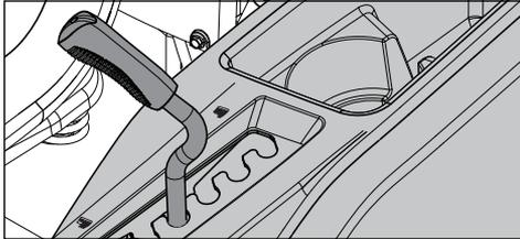
Para definir a altura de corte da plataforma, empurre a alavanca da altura de corte para dentro e desloque-a para a ranhura de altura pretendida.
