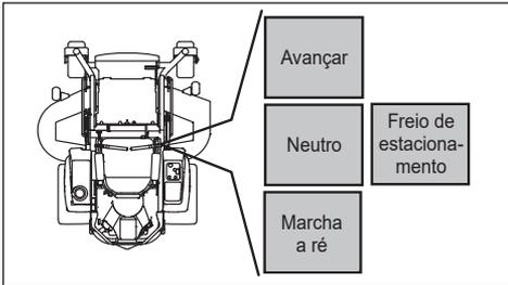
Mover de forma igual os dois controlos para a frente e para trás move a máquina numa linha reta para a frente ou para trás. Por exemplo, para virar à direita ao andar para a frente, mova o controlo direito para a posição neutra. A rotação da roda direita é diminuída e a máquina vira para a direita.
