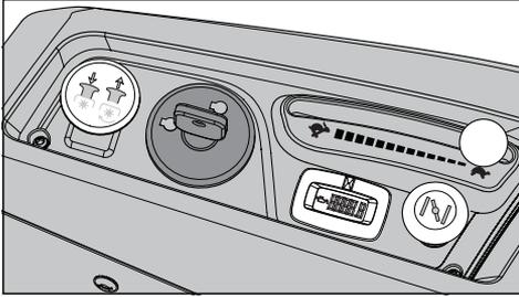
O interruptor da ignição está situado no painel de controlo e é utilizado para ligar e desligar o motor. Nos modelos equipados com faróis, rode a chave para a direita para a posição ACCESSORY para controlar a utilização dos mesmos.
