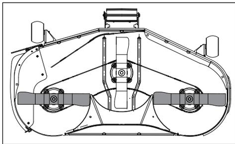
2. Meça da superfície do solo até à extremidade inferior da lâmina no lado de descarga da plataforma do corta-relvas. Registe a medição.
