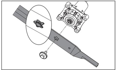
**INFORMAÇÃO IMPORTANTE** O parafuso especial da lâmina foi tratado termicamente. Se necessário, substitua por um parafuso da Husqvarna. Não utilize material de um grau inferior ao especificado.
