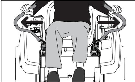
**NOTA:** Se os controlos de direção/travão de estacionamento não permanecerem em posição exterior completa, é possível ajustar a tensão apertando a porca na parte de trás do pivô. (Consulte Travão de estacionamento nesta secção).
