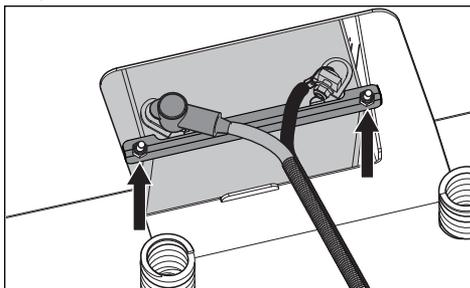
2. Utilizando duas chaves 1,27 cm (1/2 pol.), desligue o cabo PRETO da bateria e, em seguida, o cabo VERMELHO da bateria.
