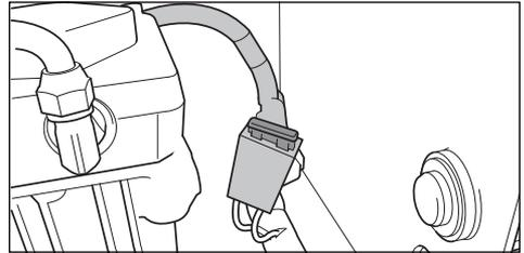
O fusível primário de 20 A está localizado do lado esquerdo da máquina. O acesso é feito inclinando o banco para a frente. O fusível é do tipo pino plano, como os utilizados nos automóveis.
