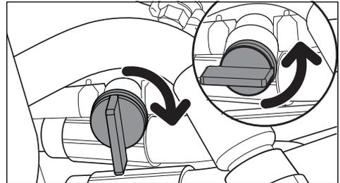
A válvula de corte de combustível está localizada na parte traseira do lado direito do banco. A válvula está desligada quando o punho está virado na perpendicular para a linha de combustível.
