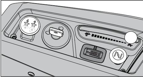
O medidor de manutenção apresenta o número total de horas de funcionamento do motor e indica quando o motor e o corta-relva necessitam de manutenção.
