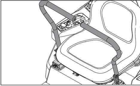
A velocidade e a direção da máquina podem ser ajustadas continuamente utilizando dois controlos de direção. Os controlos de direção podem ser movidos para a frente e para trás a partir de uma posição neutra. Existe uma posição neutra que se encontra bloqueada se os controlos de direção forem removidos.
