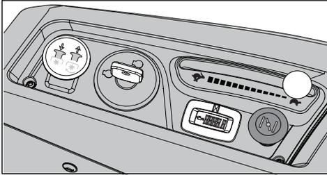
O controlo do estrangulador é utilizado para arranques a frio para garantir ao motor uma mistura de combustível mais rica. Para arranques a frio, deve-se puxar o controlo para cima.
