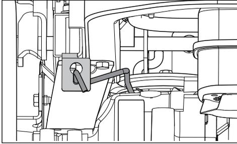
As interligações de derivação do eixo transversal têm de ser acionadas ao empurrar ou puxar o corta-relvas. As alavancas de libertação estão localizadas em cada um dos lados na parte posterior da unidade, por baixo da proteção traseira do motor. Consulte **Mover a máquina manualmente** na secção *Funcionamento*.
