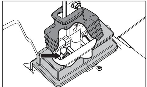
Substitua a proteção da direção, certificando-se de que a parte de cima da cobertura assenta entre os dois parafusos de ajuste do controlo da direção.
