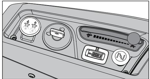
O acelerador regula a velocidade do motor e a taxa de rotação das lâminas, assumindo que o controlo da lâmina está acionado.
