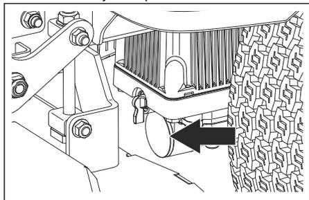
8. Installer un filtre à huile hydraulique neuf.
