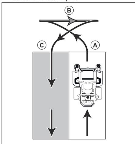
3. Tirer les deux leviers de commande pour les placer à la position de marche arrière et déplacer le produit vers l'arrière (B).
