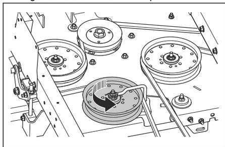
5. Retirer la courroie de l'unité de coupe de l'embrayage électrique se trouvant sur l'arbre du moteur.
