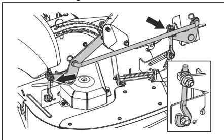
6. Tourner les deux lames extérieures pour les aligner avec l'unité de coupe de l'avant vers l'arrière.
