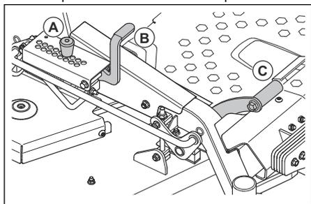
3. Appuyer sur la pédale de levage de l'unité de coupe (B) et tirer le levier de déverrouillage de transport vers l'arrière pour abaisser l'unité de coupe en position de tonte.
