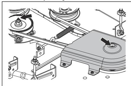
**Remarque :** Utiliser un pistolet à graisse avec un tuyau en caoutchouc pour lubrifier les tiges de l'unité de coupe.
