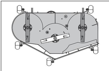
7. Régler les deux boulons avant jusqu'à ce que les pointes de lame arrière soient de 3,2 à 9,5 mm (1/8 à 3/8 po) plus élevées à l'arrière par rapport aux pointes de lame avant.
