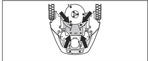
6. Rimuovere la vite della staffa di fissaggio della batteria e rimuovere la staffa.
