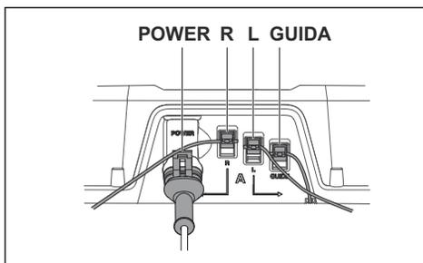
3. Invertire i collegamenti tra il cavo guida e il cavo perimetrale sulla stazione di ricarica.
