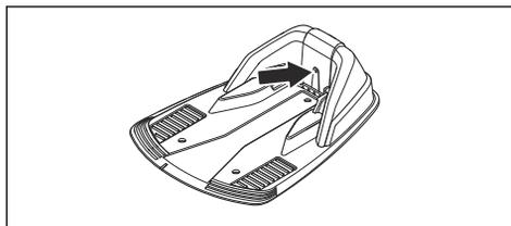
2. Verificare che i collegamenti del cavo perimetrale alla stazione di ricarica siano effettuati correttamente e non siano difettosi. Verificare che la spia della stazione di ricarica sia ancora blu e lampeggiante.
