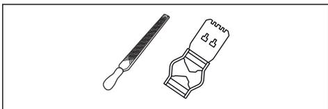
1. Nastavev globine reza prilagodite s ploščato pilo in šablono za brušenje globinskih zob. Uporabljajte samo šablono za brušenje globinskih zob za nastavev ustrezne globine in šablono za brušenje rezalnih zob družbe Husqvarna.
