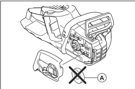
4. Platzieren Sie die Führungsschiene auf dem Schienenbolzen. Bringen Sie die Führungsschiene in ihre hinterste Stellung. Heben Sie die Sägekette über das Kettenantriebsrad, und passen Sie sie in die Nut in der Führungsschiene ein. Beginnen Sie an der Oberkante der Führungsschiene.
