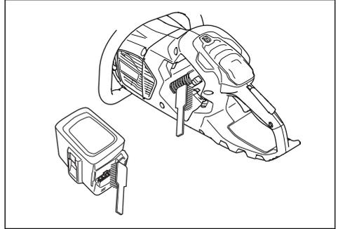
3. Stellen Sie sicher, dass der Akku nicht beschädigt oder verformt ist und dass keine sonstigen Schäden wie zum Beispiel Risse vorhanden sind.
