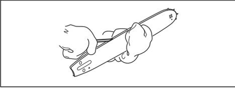
6. Kontrollieren Sie, ob der Umlenkstern der Führungsschiene sich leicht bewegen lässt und sein Schmierloch offen ist. Reinigen und schmieren Sie ihn bei Bedarf.
