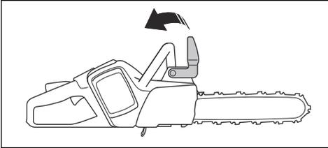
2. Lösen Sie die Spannmutter.
