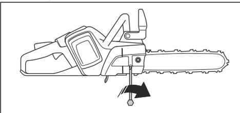
4. Ziehen Sie die Spannmutter mit dem Kombischlüssel an, und heben Sie gleichzeitig die Vorderseite der Führungsschiene an.
