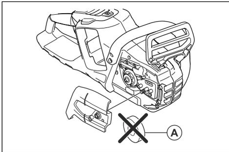
3. Na vijak meča namestite meč. Pomaknite meč v skrajno zadnji položaj. Dvignite verigo nad pogonski zobnik in jo vpnite v utor meča. Začnite na zgornji strani meča.
