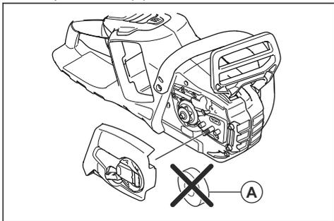
4. Na vijak meča namestite meč. Pomaknite meč v skrajno zadnji položaj. Dvignite verigo nad pogonski zobnik in jo vpnite v utor meča. Začnite na zgornji strani meča.
