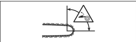
Ein Rückschlag erfolgt immer in Richtung der Führungsschiene. Normalerweise wird das Gerät
