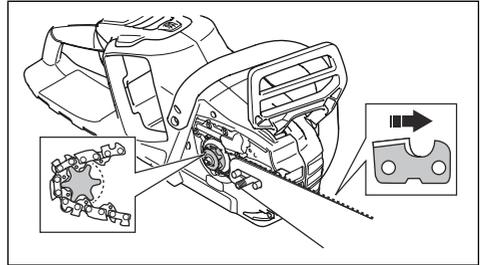
6. Installieren Sie die Abdeckung des Kettenantriebsrads, und platzieren Sie den Stift der Ketteneinstellung in der Aussparung der Führungsschiene.
