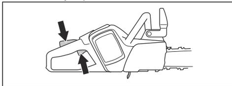
2. Zaklep sprožilnika plina pritisnite naprej (A) in navzdol (B). Zaklep sprožilnika plina pritisnite ob ročaj in se prepričajte, da se nato ob sprostitvi vrne v začetni položaj.
