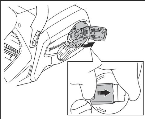
3. Entfernen Sie die Abdeckung des Kettenantriebsrads und den Transportring (A).
