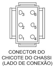
CONECTOR DO CHICOTE DO CHASSI (LADO DE CONEXÃO)
