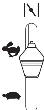
**(CZ)** Teplý motor: Nastavte páčku plynu do střední polohy - plný plyn. (👉).
