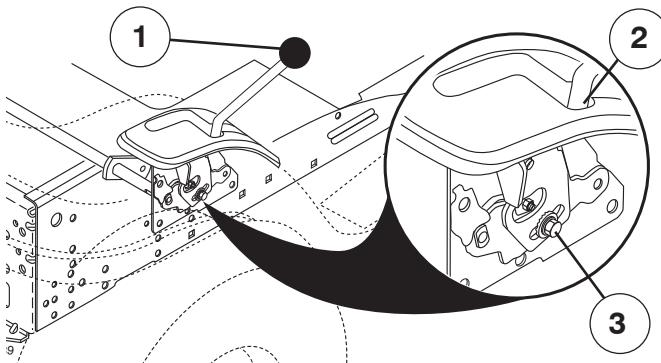
**(PL) REGULACJA LUZU NA LEWARZE STEROWANIA I NA PRZEKŁADNI RÓŻNICOWEJ**
