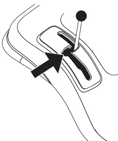
(CZ) Zcela sešlápněte pedál spojka / brzda a držte ho dolů. Řadicí páka je v poloze neutrál "N".
