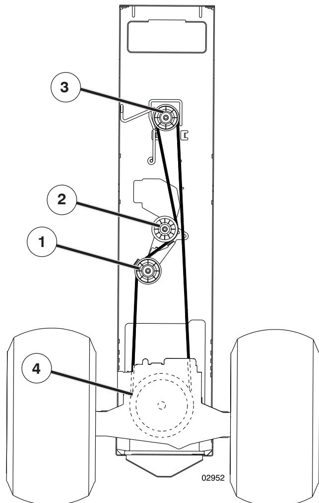
(CZ) Při zpětné montáži postupujte v opačném pořadí. Zkontrolujte, zda je řemen umístěn uvnitř všech vodítek řemenu. Při výměně používejte pouze originální řemeny.
