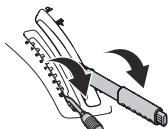
5. Натиснете надолу рамата на оборудването (A). Повдигнете блокировката на рамата на оборудването (B) във вертикално положение.
