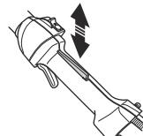
4. Proverite da li se kontrola gasa i blokada prekidača gase slobodno pomeraju i da li ispravno rade povratne opruge.
