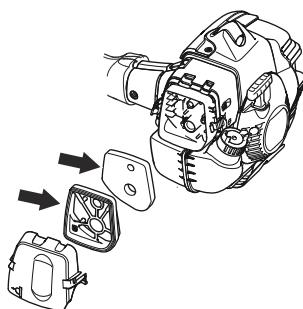
3. Očistite filter za vazduh topлом sapunjavom vodom. Uverite se da je filter za vazduh suv pre nego što ga ponovo postavite.
