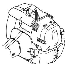
2. Skinite poklopac filtera za vazduh i uklonite filter za vazduh.
