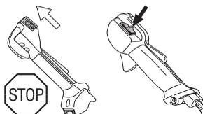
Mettere in moto e controllare che il motore si spenga portando l'interruttore in posizione di arresto.
