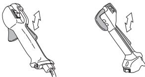
Controllare che acceleratore e fermo del gas si muovano liberamente e che le molle di richiamo funzionino a dovere.
