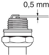
**N.B!** Usare candele originali o di tipo raccomandato! Altre candele possono danneggiare cilindro e pistone. Controllare che la candela sia munita di dispositivo di soppressione interferenze radio.
