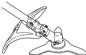
Controllare che la protezione sia integra e priva di incrinature. Sostituire la protezione se è stata sottoposta a urti o se è incrinata.
