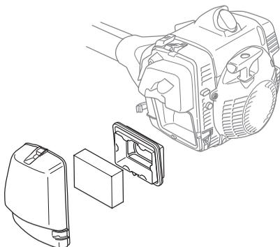
Prima di rimontare il filtro accertarsi che sia ben asciutto. Il filtro non ritorna mai completamente pulito. Pertanto va sostituito periodicamente con uno nuovo. **Un filtro danneggiato va sostituito immediatamente.**
