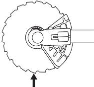
Svitando e avvitando il dado della lama per sfrascatura c'è pericolo di ferirsi con i denti della lama. Accertarsi quindi che la mano sia riparata dal paralama durante questa operazione. A questo proposito utilizzare sempre una chiave a bussola dal manico sufficientemente lungo. La freccia in figura mostra la zona di utilizzo della chiave a bussola quando si avvita e si svita il dado.
