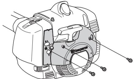
Rimuovere il filtro dell'aria e il relativo coperchio dalla macchina. Installare il filtro dell'aria e il relativo coperchio contenuti nel kit invernale.
