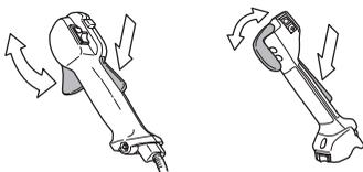
Vedi istruzioni alla voce Avviamento. Avviare il motore ed accelerare a pieno gas. Lasciar andare l'acceleratore e accertarsi che il gruppo di taglio di taglio si fermi e resti fermo. Se il gruppo di taglio ruota mentre l'acceleratore è al minimo è necessario controllare la registrazione del
