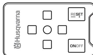
El LED verde situado en la parte central se enciende mientras que la máquina está en la posición correcta.
