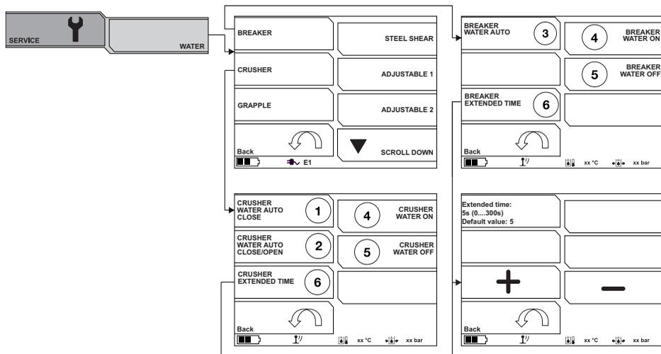
Le DXR équipé d'un kit de réduction de la poussière permet l'utilisation de la fonction eau. La fonction peut être activée avec divers outils.
