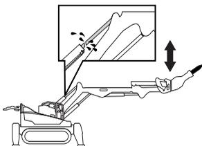
Le cylindre 3 est en position extérieure et le marteau travaille vers le bas. Ne mettez jamais les cylindres en position finale.
