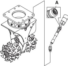
**ATTENTION !** La haveuse à tambour nécessite que le *kit d'outil de vidange* supplémentaire soit installé sur le DXR en raison de la fuite d'huile interne du modèle ER50.
