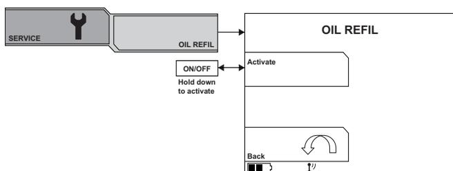
La jauge indique le niveau d'huile en pourcentage, au dixième près. Maintenez la touche de sélection enfoncée pour effectuer le remplissage d'huile. La pompe s'arrêtera automatiquement lorsque le réservoir est plein.
