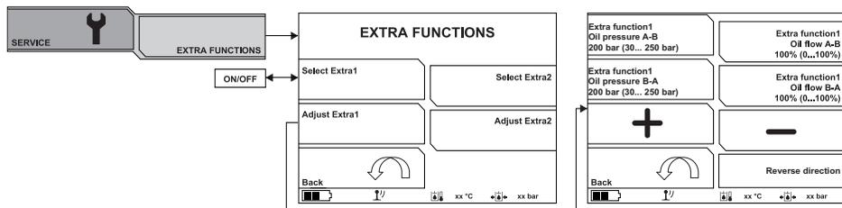
La machine peut être équipée de soupapes supplémentaires pour pouvoir utiliser plus de fonctions, notamment un rotor et une inclinaison.
