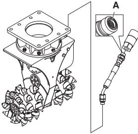
**ATTENTION !** Dans le *kit d'outil de vidange* se situe un filtre (A) dans l'adaptateur entre le tube et le raccord rapide.
