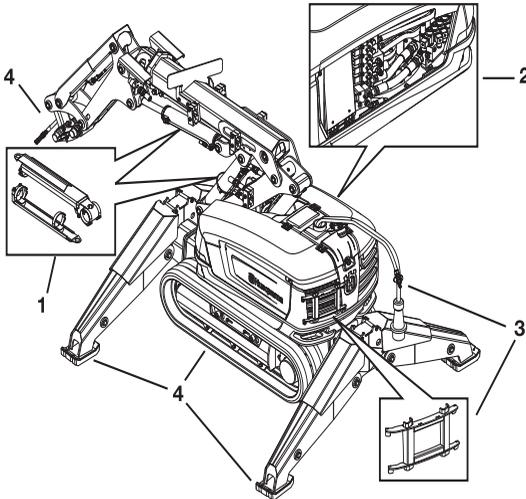
Les machines peuvent être équipées de 3 différents groupes d'accessoires après-vente (ou montées en usine).
