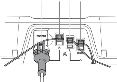
3. Invertire i collegamenti tra il cavo guida e il cavo perimetrale sulla stazione di ricarica.
