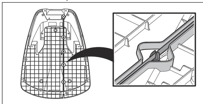
2. Montare il connettore sul cavo guida come è stato fatto per il cavo perimetrale, seguendo le istruzioni riportate in *Collegamento del cavo perimetrale alla pagina 18*. Collegarlo al connettore di contatto sulla stazione di ricarica indicato con GUIDE.
