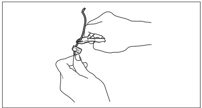
4. Premere il connettore sullo spinotto metallico, premere il connettore sullo spinotto di contatto, contrassegnato con L (sinistra) e R (destra), sulla stazione di ricarica. Controllare con cura che il connettore sia fissato correttamente.
