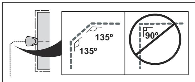
4. Condurre il cavo guida fino al punto del cavo perimetrale sul quale è stato precedentemente aggiunto un anello per facilitare il collegamento del cavo guida.
