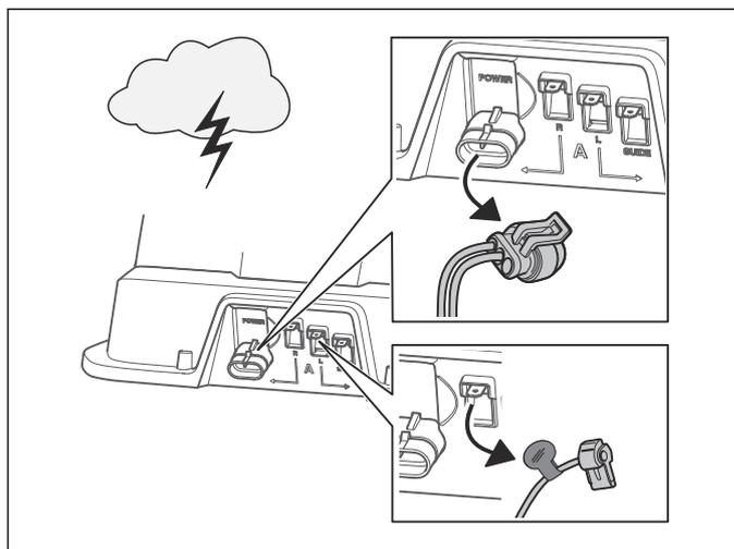
Per ridurre il rischio di danni a componenti elettrici del rasaerba robotizzato e della stazione di ricarica, si consiglia di scollegare tutte le connessioni alla stazione di ricarica (alimentazione, cavo perimetrale e cavi guida) in caso di rischio di temporali.
