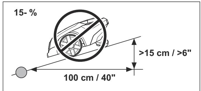
Comunque, nel caso in cui sia presente un ostacolo, ad esempio una recinzione o una siepe fitta, che il robot rasaerba può urtare senza pericolo, il cavo perimetrale può essere posizionato lungo una pendenza superiore al 15%.
