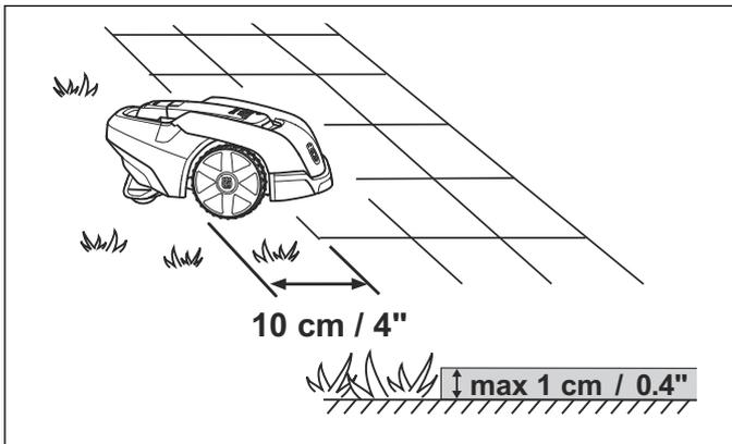
Se l'area di lavoro è divisa da una pavimentazione in selciato a livello con il prato, è possibile consentire al robot rasaerba di salire sulla pavimentazione. Può essere un vantaggio posare il cavo perimetrale sotto la pavimentazione. Il cavo perimetrale può anche essere posato tra le fughe delle pietre del selciato. Verificare che le mattonelle siano livellate rispetto al prato per evitare un'usura eccessiva del robot rasaerba.
