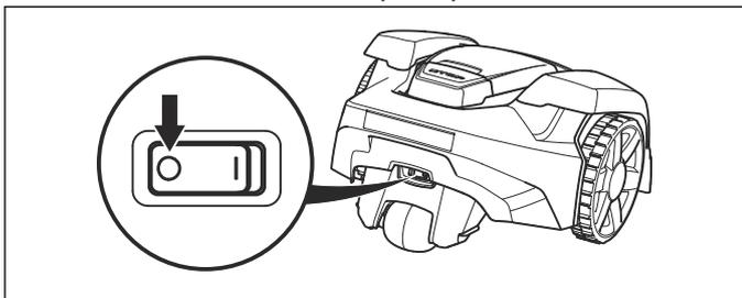
Spegner sempre il rasaerba robotizzato con l'interruttore principale se è necessaria manutenzione o se il rasaerba robotizzato deve essere usato all'esterno dell'area di lavoro.
