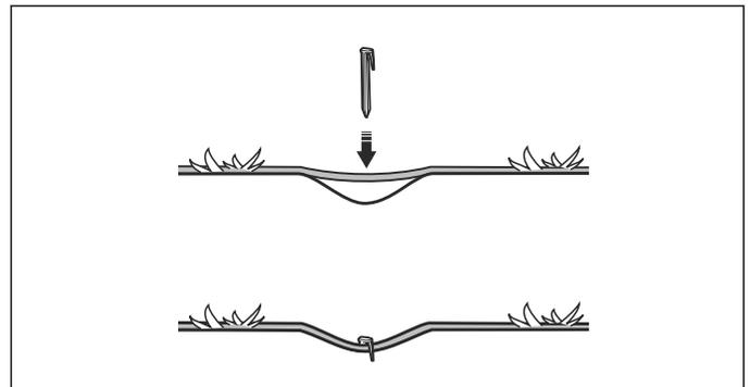
Non avvolgere mai il cavo a bassa tensione per riporlo, né collocarlo sotto la piastra base della stazione di ricarica, per evitare interferenze con i segnali della stazione stessa.
