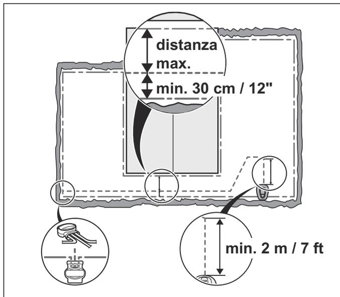
Come il cavo perimetrale, anche il cavo guida può essere fissato a terra con picchetti o interrato.
