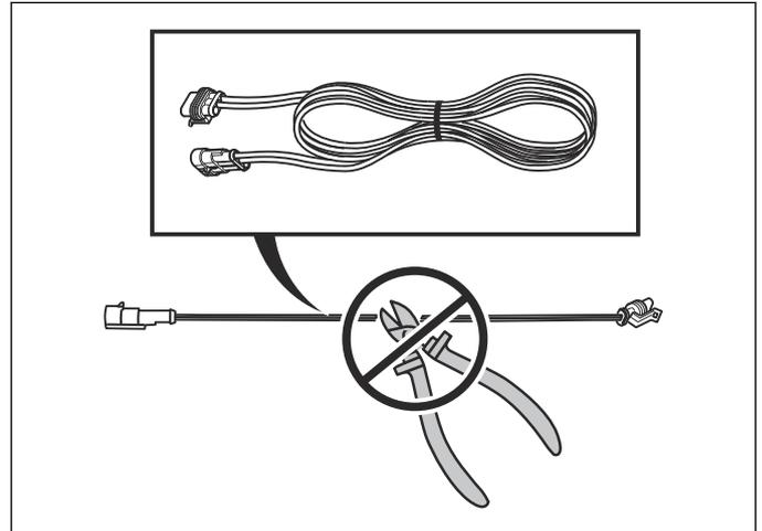
È possibile lasciare che il cavo a bassa tensione attraversi l'area di lavoro se questo è fissato con picchetti o interrato. L'altezza di taglio deve essere tale da impedire alle lame di entrare in contatto con il cavo a bassa tensione.
