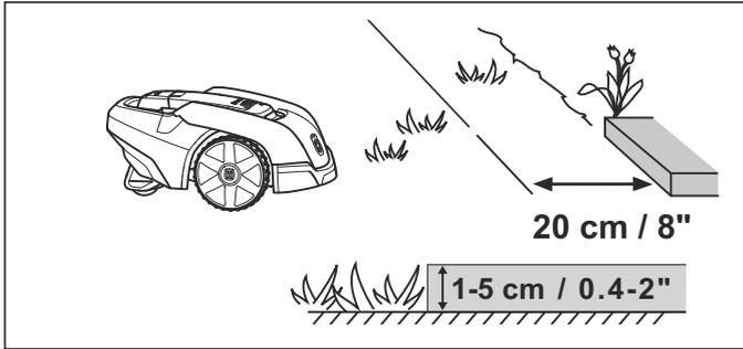
Se l'area di lavoro confina con una pavimentazione in selciato o una simile a livello con il prato (+/- 1 cm), è possibile consentire al rasaerba di salire leggermente su di essa. Il cavo perimetrale deve essere posato a 5 cm dal bordo della pavimentazione. Tutta l'erba lungo i lati della pavimentazione sarà tagliata.
