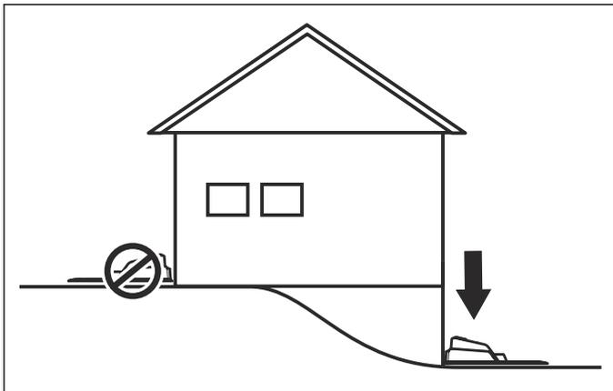
La stazione di ricarica non deve essere installata su un'isola poiché così facendo si riducono le possibilità di posizionare il cavo guida in modo ottimale. Se tuttavia la stazione di ricarica deve essere necessariamente installata su un'isola, anche il cavo guida deve essere collegato all'isola. Per maggiori informazioni sulle isole, leggere *Confini all'interno dell'area di lavoro alla pagina 15*.
