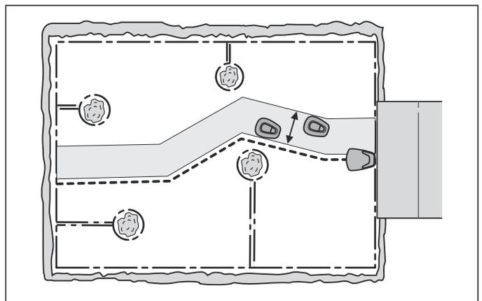
Il rasaerba robotizzato lavora a distanze diverse dal cavo guida per ridurre il rischio di tracciare solchi. L'area accanto al cavo usata dal rasaerba robotizzato è chiamata Corridoio. Più ampio è il corridoio consentito dall'installazione, minore è il rischio di formare solchi.
