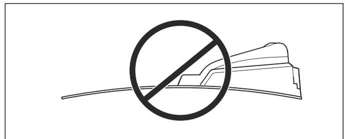
Se l'installazione viene effettuata in un'area di lavoro con pendenza ripida, la stazione di ricarica deve essere posizionata in fondo al pendio. In questo modo è più semplice per il robot rasaerba seguire il cavo guida fino alla stazione di ricarica.
