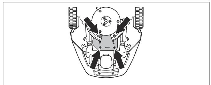
6. Svitare la vite della staffa di fissaggio della batteria e rimuovere la staffa.
