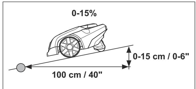
Il cavo perimetrale non deve essere posato su una pendenza superiore al 15%. È possibile che il robot rasaerba faccia fatica a cambiare direzione in questo punto. Il robot rasaerba si arresta e viene visualizzato il messaggio di errore *Fuori area lavoro*. Il rischio è maggiore in condizioni di umidità, dato che le ruote possono scivolare sull'erba bagnata.
