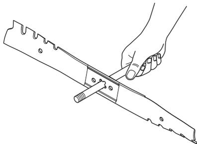
**IMPORTANT!** Les lames doivent être équilibrées après l'affûtage. Nous ne recommandons pas d'affûter la lame. L'affûtage et l'équilibrage de la lame doivent être effectués par un atelier agréé.
