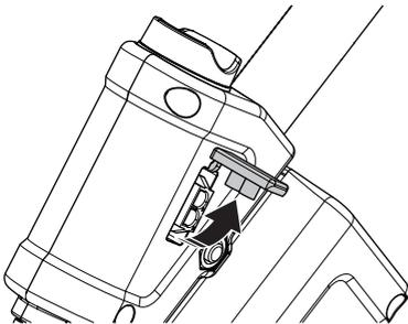
2. Brancher le connecteur (mâle) du chargeur de batterie au connecteur (femelle) du module de démarrage.
