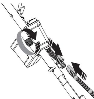
**IMPORTANT :** S'assurer que le dispositif de verrouillage à cliquet sur la vis à oreilles est engagé pour empêcher que la vis ne se desserre pendant le fonctionnement.
