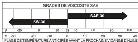
**MISE EN GARDE!** Bien que les huiles multigrades (5W30, 10W30, etc.) améliorent le démarrage par temps froid, elles occasionnent l'augmentation de la consommation d'huile lorsqu'on les utilise à une température supérieure à 0 °C. Vérifier le niveau d'huile moteur plus fréquemment pour éviter d'éventuels dommages par manque d'huile.
