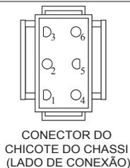
CONECTOR DO CHICOTE DO CHASSI (LADO DE CONEXÃO)
