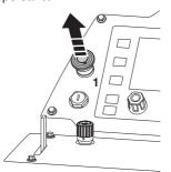
Ripristinare la modalità di sicurezza portando l'interruttore di avviamento del motore nella posizione STOP e nuovamente nella posizione di accensione.
