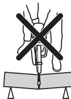
Se il disco è schiacciato o bloccato nel settore di contraccolpo, la forza di reazione respingerà la troncatrice in senso rotatorio in alto e indietro verso l'utente causando lesioni gravi o mortali. Fare attenzione al possibile spostamento del pezzo in lavorazione. Se esso non è adeguatamente supportato e si sposta durante il taglio, potrebbe schiacciare la lama e causare un contraccolpo.
