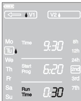
1. Seleccionar válvula 1 (← **V1**) o válvula 2 (**V2** →) con las teclas ▼-▲.
