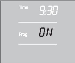
Con el fin de ejecutar el programa de riego, se tiene que seleccionar **Prog ON**. Con **Prog OFF** se desactiva el riego automático. **Prog ON / OFF** se puede seleccionar independientemente para cada válvula. También con **Prog OFF** se puede regar manualmente.
