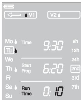
Se memoriza la duración de apertura manual modificada, es decir, cada vez que en el futuro se abra la válvula manualmente, el programador utilizará la duración de apertura modificada. Si la duración de apertura manual se cambia a **0:00**, la válvula se cerrará y permanecerá cerrada aunque se pulse la tecla **Man.** (seguro para evitar que los niños manipulen el programador).
