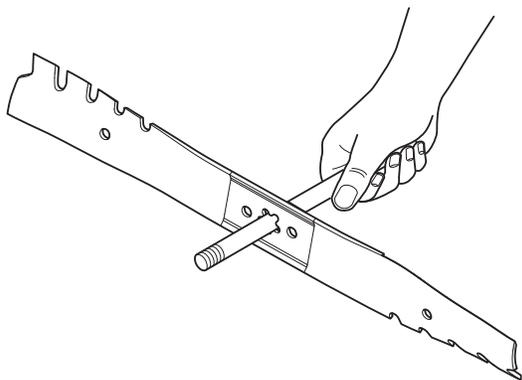
**IMPORTANT !** Équilibrez les lames après leur affûtage. Il n'est pas recommandé d'affûter les lames. L'affûtage et l'équilibrage des lames doit être effectué dans un atelier d'entretien agréé.
