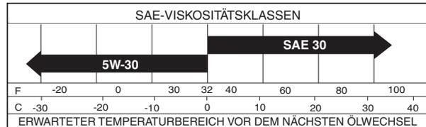
**ACHTUNG!** Mehrbereichsöle (5W30, 10W30 usw.) verbessern das Startverhalten bei kaltem Wetter, aber bei Temperaturen über 0 °C steigt der Ölverbrauch. Prüfen Sie in diesem Fall öfter den Ölstand, damit es nicht durch einen zu niedrigen Ölstand zu Motorschäden kommt.
