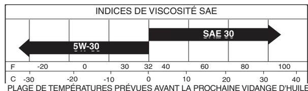
**MISE EN GARDE !** Si les huiles multi-viscosité (5W30, 10W30, etc.) améliorent le démarrage par temps froid, elles ont pour effet d'augmenter la consommation d'huile lorsqu'elles sont utilisées à des températures supérieures à 0 °C (32 °F). Vérifiez fréquemment le niveau d'huile pour éviter qu'une insuffisance d'huile endommage le moteur.
