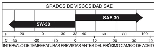
**ATENCIÓN:** Aunque los aceites de viscosidad multigrado (5W30, 10W30, etc.) facilitan el arranque a bajas temperaturas, incrementan su consumo cuando se utilizan por encima de 0°C. Compruebe con frecuencia el nivel de aceite para evitar que el motor se dañe si el nivel es bajo.
