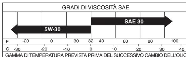
**ATTENZIONE!** Sebbene gli oli multiviscosi (5W30, 10W30 ecc.) migliorino l'avviamento a basse temperature, causano un maggior consumo di olio se utilizzati oltre 32°F. Controllare il livello dell'olio motore più frequentemente per evitare possibili danni al motore dovuti a una quantità insufficiente di olio.
