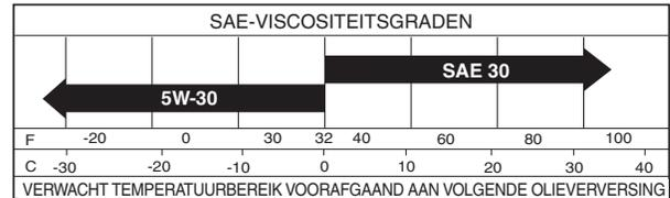
**VOORZICHTIG!** Hoewel het gebruik van multi-viscositeitsoliën (5W30, 10W30, enz.) het starten bij koud weer vereenvoudigen, zorgen deze voor een verhoogd oliegebruik bij gebruik boven 32° F. Controleer uw motoroliepeil vaker om mogelijke schade aan de motor door draaien met te weinig olie te voorkomen.
