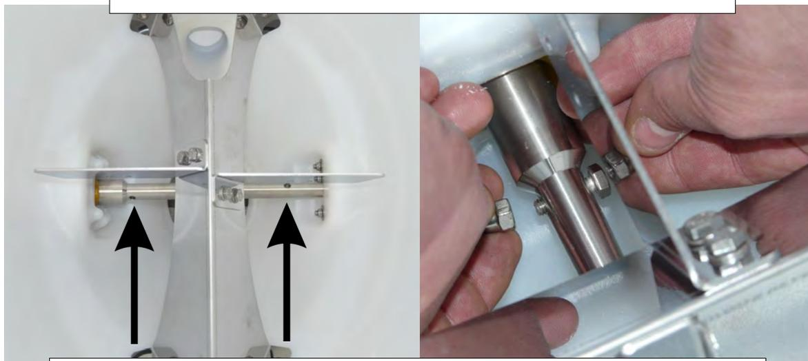
**Introduire la vis M6x25 dans le bras agitateur par les orifices indiqués en rouge, puis la fixer avec l'écrou borgne M6.**
