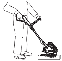
Çalışma pozisyonu 3: Asılı çim uçlarında dikine kırma
