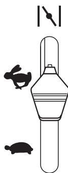
**(RU)** Разогретый двигатель: переместите регулятор газа на пол-пути в положение полного газа “
