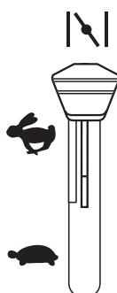
**RU** Холодный двигатель: приведите регулятор газа в крайнее положение choke (|\|).
