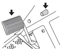
Premere delicatamente uno dei pedali di regolazione della velocità fino a raggiungere l'andatura desiderata. Nella marcia in avanti si usa il pedale (1) e per la retromarcia il pedale (2).
