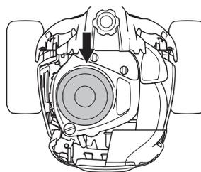
Un intasamento della grata, del condotto o della presa dell'aria refrigerante compromette il raffreddamento del motore con conseguente rischio di danni.
