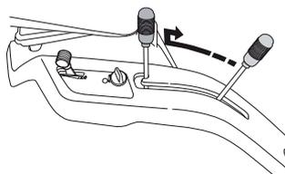
Spostando la leva in avanti, il piatto di taglio viene abbassato e i dischi iniziano automaticamente a ruotare (posizione di taglio).
