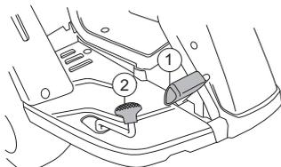
Il **FR2312 M** è dotato di pedale del freno e pulsante di bloccaggio sul lato destro. Disinnestare il freno di stazionamento premendo il pedale del freno di stazionamento e rilasciandolo.
