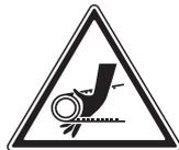
Spegnere il motore e staccare il cavo della candela prima di riparazioni o manutenzione
