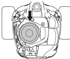
A refrigeração do motor é prejudicada, podendo resultar em danos ao motor se a grade da entrada do ar, condutor do ar ou entrada de ar refrigerado estão entupidas.
