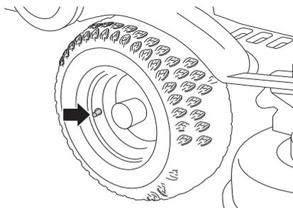
**INFORMAÇÃO IMPORTANTE** Pressão de ar diferente em cada pneu dianteiro implica que as lâminas irão cortar a relva a alturas diferentes.
