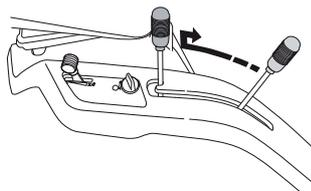
Se deslocar a alavanca para a frente, a plataforma de corte será baixada e as lâminas começarão a rodar automaticamente (posição de corte).
