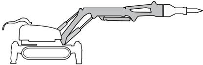
Das Armsystem besteht aus drei Komponenten, um höchstmögliche Beweglichkeit, große Reichweite und Kompaktheit zu gewährleisten. Erweiterbare Wellen minimieren das Risiko von Spielraum innerhalb der Verbindungsstellen.
