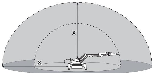
Der Arbeitsbereich stimmt mit der Reichweite der Maschine überein. Dagegen hängt der Umfang des Sicherheitsbereichs von Arbeitsweise, Gegenstand, Untergrund usw. ab. Überprüfen Sie den Arbeitsplatz auf mögliche Gefahren hin. Bei Änderungen der Arbeitsumstände muss der Umfang des Sicherheitsbereichs erneut festgelegt werden.
