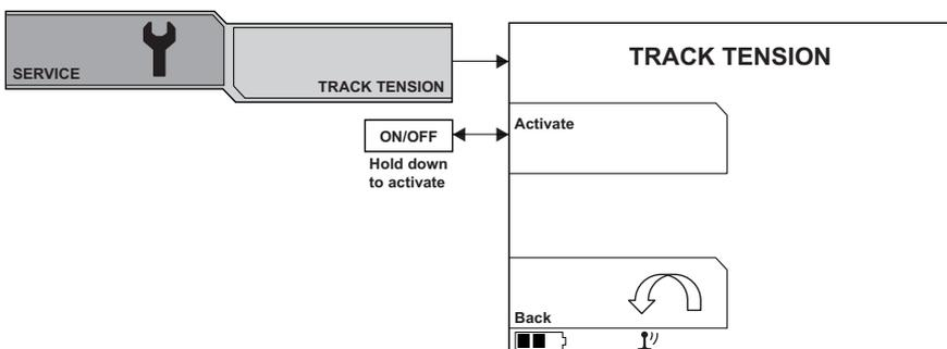
Halten Sie die Wahltaaste für die Aktivierung der Kettenspannung gedrückt.
