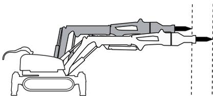
Die Maschine ist zusätzlich mit einem Teleskoparm ausgestattet, der eine Erhöhung der Reichweite ermöglicht. Der Standort der Maschine sollte möglichst nah am Arbeitsbereich liegen, um die optimale Leistungsfähigkeit des Armsystems und der Zylinder zu auszunutzen.
