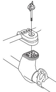
Montare l'impugnatura destra del manubrio con la vite, la rondella, la bussola e il dado, in base alla figura. Serrare.
