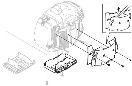
**IMPORTANTE!** A temperature superiori a 5 °C è **OBBLIGATORIO** riconvertire la macchina alla versione standard. In caso contrario sussiste pericolo di surriscaldamento, con conseguenti gravi danni al motore.
