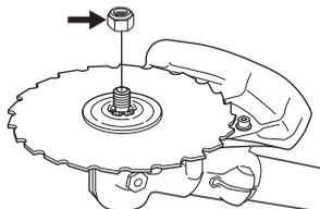
Durante il montaggio, avvitare il dado girando in senso contrario a quello di rotazione del gruppo di taglio. Durante lo smontaggio, svitare il dado nel senso di rotazione del gruppo di taglio. (NOTA! La filettatura del dado è sinistrorsa.)
