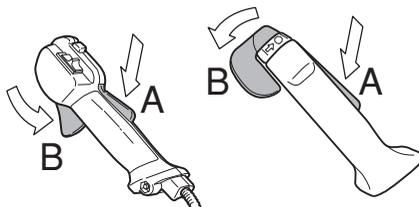
Controllare che l'acceleratore sia bloccato sul minimo quando il fermo è in posizione di riposo.
