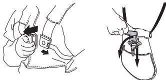
Controllare che le cinghie dell'imbracatura siano nella giusta posizione. Quando l'imbracatura e la macchina sono state regolate, controllare che il dispositivo di sgancio rapido funzioni.
