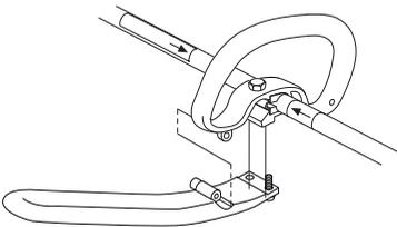
Voer nu de fijnafstelling uit voor een comfortabele werkhouding. Draai de bouten vast.
