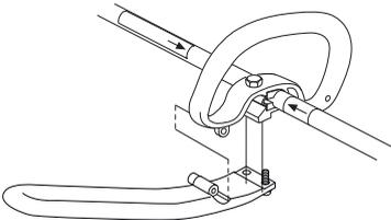
Effectuer un réglage d'appoint pour obtenir une position de travail confortable. Serrer les vis.
