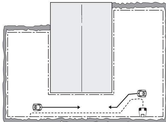
Nepokládejte kabel v ostrých úhlech. Může to vést k tomu, že sekačka nemůže správně sledovat naváděcí kabel.
