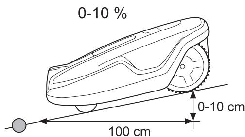
Ohraničující vodič by neměl být položen ve svahu, který má větší sklon než 10 %. Pro sekačku Automower® by mohlo být obtížné se zde otočit. Sekačka se pak zastaví a zobrazí chybové hlášení *Mimo pracovní plochu*. Největší nebezpečí hrozí při deštivém počasí, neboť kola mohou na mokré trávě prokluzovat.
