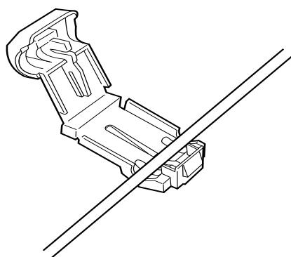
4. Zmáčkněte konektor pomocí kleští. Svírejte kleště, dokud neuslyšíte cvaknutí.
