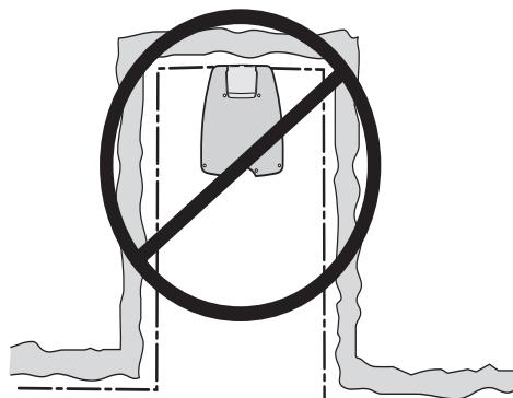
Vyhnete se umístění nabíjecí stanice v úzkém průchodu (užším než 3 metry).
