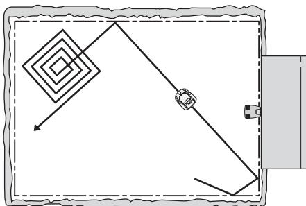
Jestliže sekačka Automower® vjede do oblasti, kde cítí, že je tráva delší než dříve, může změnit vzorec pohybu. Může začít sekat do tzv. čtvercového vzorce, kterým pokryje oblast s vyšší trávou a sečení probíhá více systematicky.
