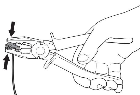
5. Ostříhněte přebývající kus vodiče. Vodič ustříhněte 1-2 cm nad konektorem.
