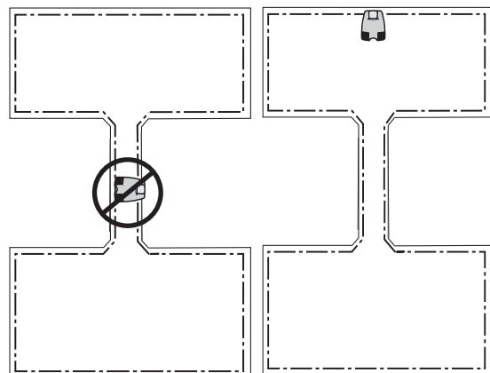
Neumísťujte nabíjecí stanici tak, aby se sekáčka mohla dostat blíže než 3 metry za nabíjecí stanici (např. na úzkém poloostrovku). Sekáčka v tom případě nenajde svou nabíjecí stanici.
