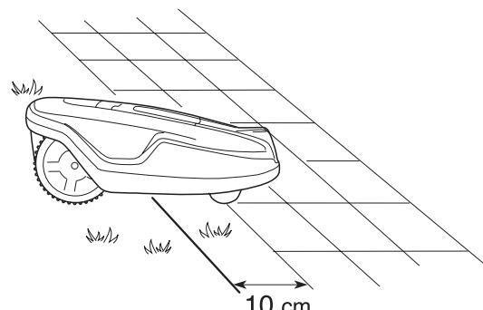
Pokud je pracovní plocha rozdělena rovnou cestou z dlaždic nebo z podobného materiálu a je ve stejné úrovni jako travnatá plocha, je možné, aby sekačka Automower® přejízděla přes tuto cestu. Může být výhodné položit ohraničující vodič pod dlaždice. Ohraničující vodič může být také položen do mezery mezi dlaždicemi.
