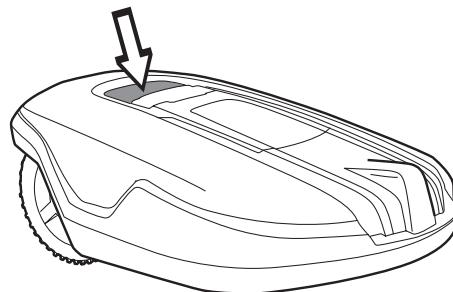
Ovládací panel se skládá z displeje a klávesnice. Všechny informace jsou zobrazeny na displeji a všechna zadání jsou prováděna pomocí tlačítek.
