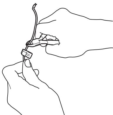
6. Zasuňte konektor na kovový kontakt s označením A na nabíjecí stanici.
