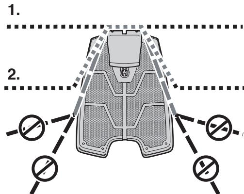
Při zapojování k nabíjecí stanici musí být pravý konec vodiče ohraňující smyčky protažen pravým otvorem a levý konec vodiče levým otvorem ve spodní části nabíjecí stanice.
