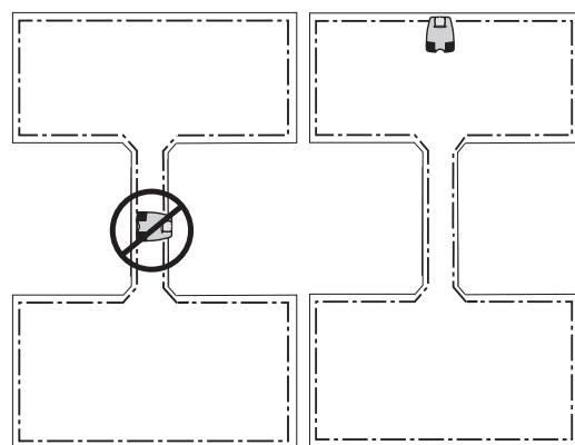
Не размещайте зарядную станцию в узких местах (проходы уже 3-х метров). Это затруднит поиск зарядной станции газонокосилкой.
