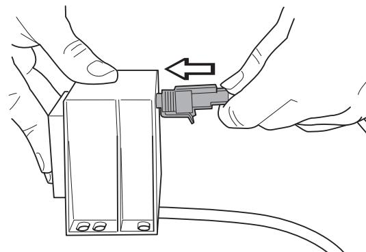
5. Подключите силовой кабель трансформатора к сетевой розетке 230 В. Рекомендуется использовать автомат для защиты от замыкания на землю.
