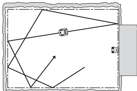
Если Automower® входит в зону с более высокой травой, алгоритм движения может быть изменен. В таком случае может использоваться алгоритм прямолинейных движений для более систематической обработки зоны с высокой травой.
