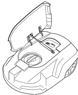
3. Переведите переключатель в требуемое положение. Положение путем установки метки на переключателе напротив соответствующего значения, нанесенного на корпус газонокосилки.
