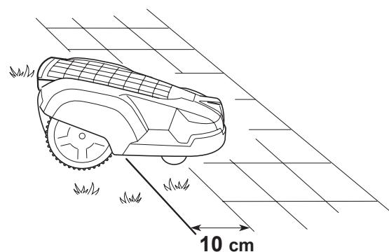
Если рабочая зона граничит с мощенной дорожкой на одном уровне с газоном, допускается небольшой заход газонокосилки на территорию такой дорожки. Возможно, более целесообразным будет прокладка граничного кабеля под дорожкой. Граничный кабель также можно прокладывать в местах стыка между плитками.
