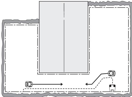
То же минимальное расстояние (30 см) также должно выдерживаться между направляющим кабелем и кабелем, проходящим по проходу.
