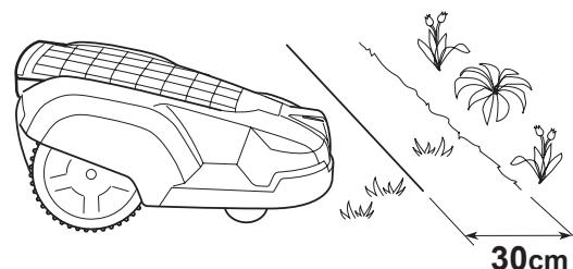
Если рабочая зона граничит с ровным проходом и т.п. на одном уровне с газоном, допускается небольшой заход газонокосилки на территорию такого прохода. В таком случае граничный кабель должен прокладываться на расстоянии 10 см от края прохода.
