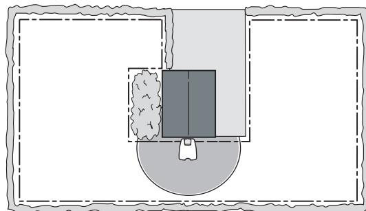
Станцию нужно устанавливать на относительно ровной местности. Разница уровней для передней и задней части зарядной станции не должна превышать 5 см.
