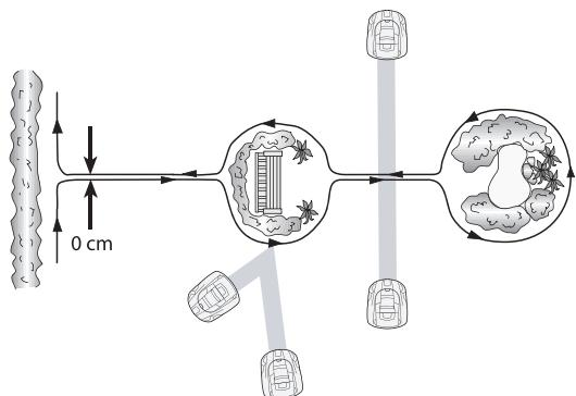
Предметы, которые могут выдерживать столкновение с газонокосилкой, например деревья или кустарники высотой более 15 см, не нужно отделять с помощью граничного кабеля. При столкновении с такими объектами машина просто повернет в другую сторону.
