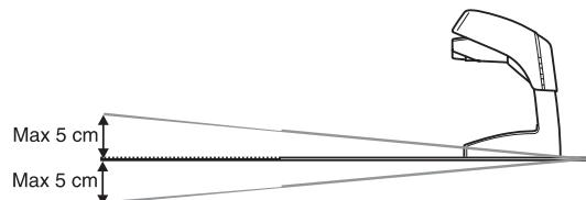
Не допускается установка зарядной станции с прогибом базовой пластины.
