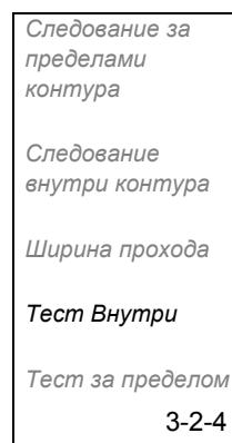
При выборе данной функции машина будет сразу следовать вдоль граничного кабеля, напр. провода 1 или напр. провода 2 (в зависимости от того, что будет найдено раньше) до зарядной станции. Если газонокосилка не может пройти через одну из дорожек, это означает, что выбрано слишком высокое значение **Ширины прохода**. Если активирована функция Тест Внутри, газонокосилка проходит на большем расстоянии от кабеля, чем позволяют настройки ширины прохода.
