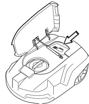
Панель управления состоит из дисплея и клавиатуры. Информация отображается на дисплее, ввод данных осуществляется с использованием кнопок на клавиатуре.
