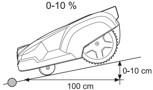
Границный кабель нельзя укладывать на склонах с уклоном более 10 %. Существует риск возникновения затруднений при проходе газонокосилки по таким склонам. В этом случае газонокосилка остановится и будет выведено сообщение об ошибке *Вне рабочей зоны*. При влажной погоде риск возникновения такой ошибки повышается, поскольку колеса могут проскальзывать на влажной траве.
