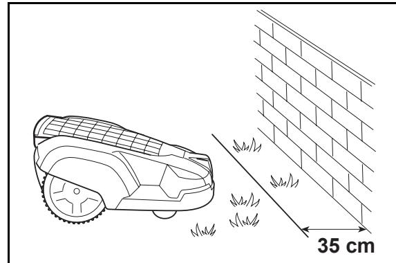
Если рабочая зона граничит с небольшой канавой, например с клумбой, или с небольшой возвышенностью, например с небольшой каймой (3 - 5 см), граничный кабель должен прокладываться за 30 см до такого препятствия. Это предотвратит попадание колес в канаву или на возвышность.
