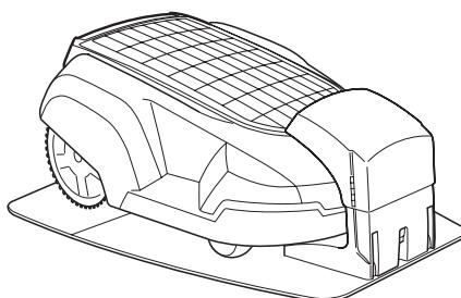
После выбора ПИН-кода на газонокосилке, которая расположена на зарядной станции, связь между газонокосилкой и зарядной станцией будет установлена.
