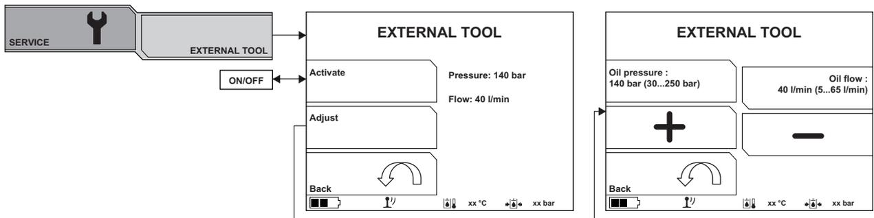
Die Maschine kann als Stromquelle zum Betreiben externer Hydraulikwerkzeuge verwendet werden.
