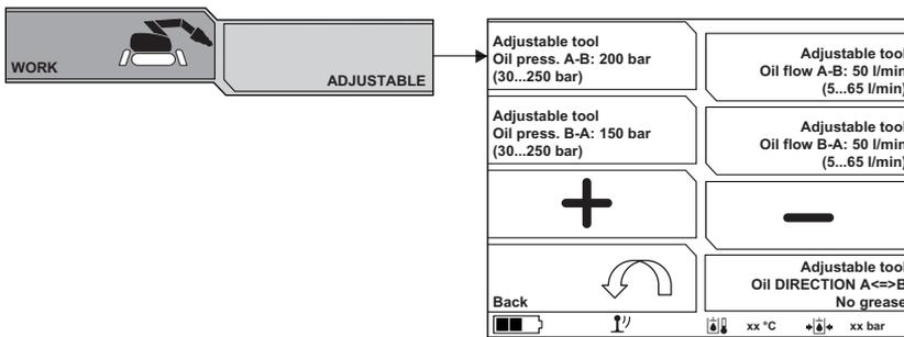
Wird für Arbeiten mit einem Werkzeug, das kein Standardwerkzeug ist, gewählt.
