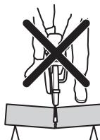
Wird die Klinge eingeklemmt oder bleibt sie im Rückschlagbereich stecken, kann die Heftigkeit der Rückschlageffekts zu heftigen Drehbewegungen und starkem Wackeln des Trennschleifers führen, was schwere oder tödliche Verletzungen verursachen kann. Auf mögliche Bewegungen des Werkstücks achten. Wenn das Werkstück nicht ausreichend gestützt ist und sich beim Schneiden verschiebt, kann es durch Einklemmen der Trennscheibe zu einem Rückschlag kommen.
