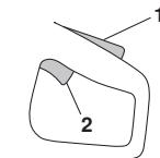
Cuando se suelta la empuñadura, el acelerador y el fiador del acelerador vuelven a sus respectivas posiciones iniciales. En esta posición, la máquina se detiene y el acelerador se bloquea, mientras que la válvula de agua vuelve a la posición cerrada.
