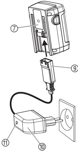
4. Primeiro, desconectar a ficha do cabo de carga ⑨ da bateria ⑦ e, em seguida, desligar o carregador ⑩ da corrente.
