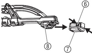
1. Pressionar as duas teclas de bloqueio ⑥ e retirar a bateria ⑦ do receptáculo ⑧ segurando pela pega.
