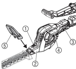
**A** Manter premida a tecla (1) e inclinar a cabeça oscilante (2)  $90^{\circ}$  (ver em 5. Operação "Inclinar cabeça oscilante").
