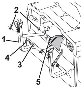
**ПРИМЕЧАНИЕ:** Крюк с защелкой должен проходить только через разгрузочный желоб. Крюк не должен входить в прорезь на заднем щитке трактора. Это обеспечит плавное качание разгрузочного желоба вместе с декой косилки при движении по бугристой поверхности.
