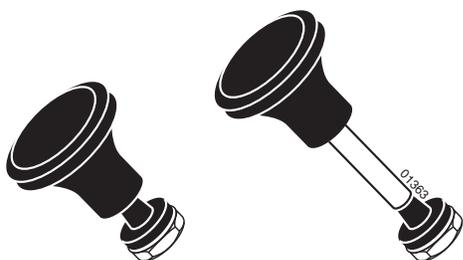
**(RU)** Потяните на себя регулятор воздушной заслонки (если двигатель холодный).
