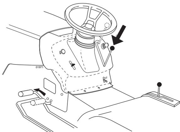
**RU 5. Подключение/отключение режущего блока.**
