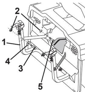
**OBSERVAȚIE:** Cârligul trebuie să ajungă numai la jgheabul de golire. Nu lăsați cârligul să intre în nișa plăcii posterioare a tractorului. Acest lucru ar permite ca jgheabul de golire să se miște împreună cu platforma agregatului de cosire în cazul unui teren denivelat.
