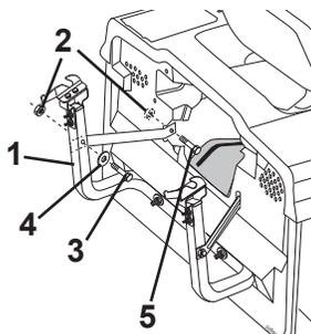
**IEVĒROJIET:** Āķim ir jāiet cauri tikai izsviešanas vadam. Neļaujiet āķim ieiet traktora aizmugurējās plates gropē. Tas ļaus izsviešanas vadam kustēties saskaņoti ar plāvēja grīdu, virzoties pa nelīdzenu virsmu.
