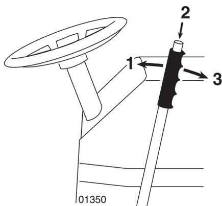
**RU 6. Быстрый подъем/опускание режущего блока**
