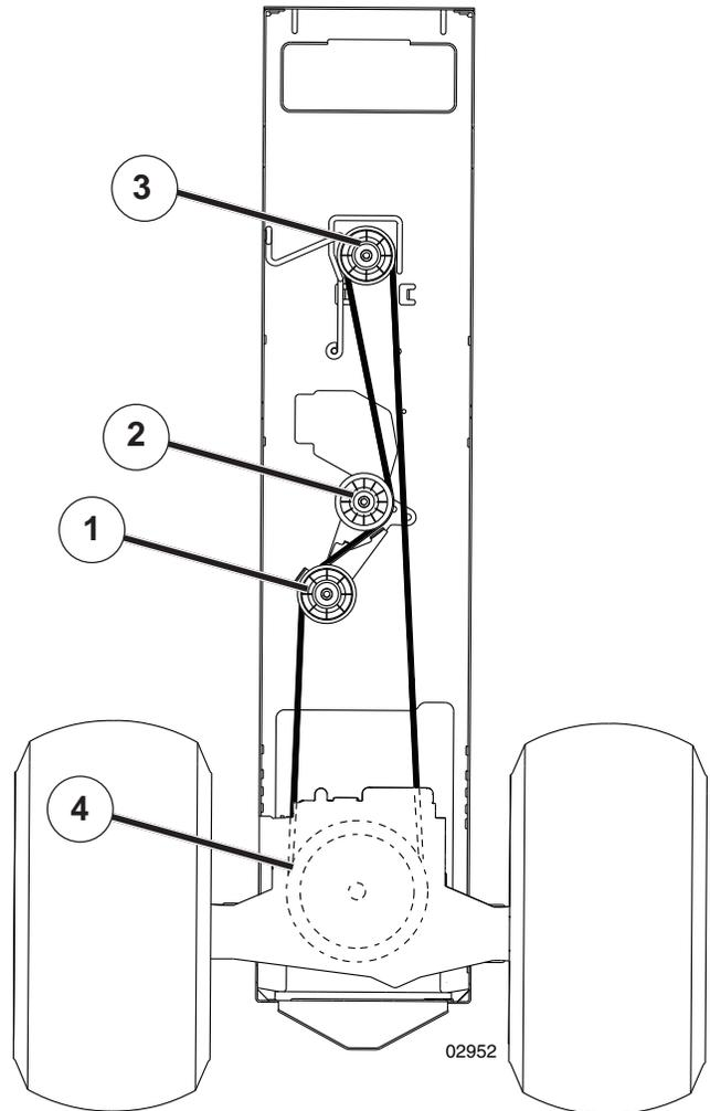
**(SE)** Montering sker i omvänd ordningsföljd mot demontering. Kontrollera att remmen ligger innanför samtliga remstyrare. Använd enbart originalrem vid byte!
