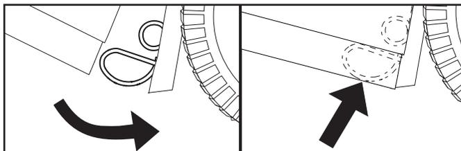
**ΣΗΜΕΙΩΣΗ:** Εάν ρυθμιστεί το ύψος του συγκροτήματος διάταξης σάκου, ενδέχεται να απαιτείται ρύθμιση του μανδάλου ελατηρίου της διάταξης σάκου. Για να πραγματοποιηθεί η ρύθμιση, αφαιρέστε το παξιμάδι (4) και μετακινήστε το μάνδαλο ελατηρίου της διάταξης σάκου στην κατάλληλη οπή στην πίσω πλάκα (1). Βεβαιωθείτε ότι το συγκρότημα διάταξης σάκου κλείνει με ασφάλεια. Σφίξτε ξανά καλά το παξιμάδι.
