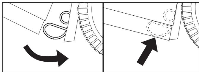
**NOTA:** Se a altura do conjunto do ensacador for ajustada, pode ser necessário ajustar o trinco de mola do ensacador. Para ajustar, retire a porca (4) e desloque o trinco de mola para o orifício adequado na placa traseira (1) garantindo que o conjunto do ensacador fica bem fechado. Volte a apertar bem a porca.
