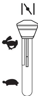
**SE** Vid kall motor: Skjut gasreglaget uppåt till ändläget "CHOKE" (|X|).
