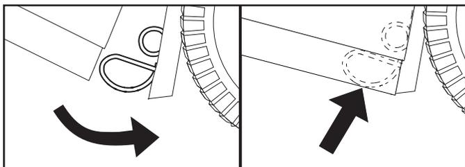
**OBS!** Om påsenhetens höjd justeras kan det bli nödvändigt att även justera påsenhetens fjäderläsregel. För att justera denna, avlägsna muttern (4) och flytta fjäderläsregeln till korrekt hål på den bakre plattan (1), se till att påsenheten är korrekt stängd. Dra åt muttern ordentligt.
