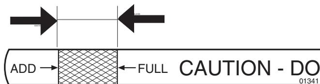
**SE** Oljenivån skall ligga mellan de båda markeringarna på stickan. Om så inte är fallet skall motorolja SAE 30 fyllas till "FULL"-markeringen. Vintertid (under fryspunkten) skall motorolja SAE 5W-30 användas.
