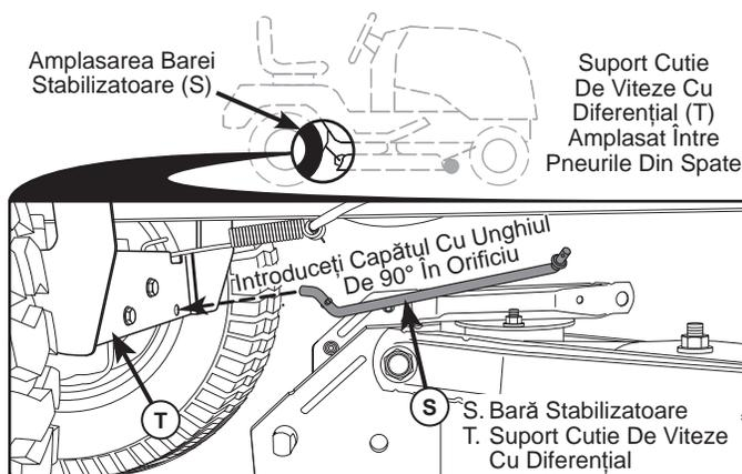
**NOTĂ:** În funcție de model, suportul (T) poate fi diferit de cel din desen, dar orificiul pentru bara stabilizatoare va fi situat în aceeași poziție/amplasare.
