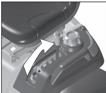
ⓇⓊ **6. Быстрый подъем/опускание режущего блока**
