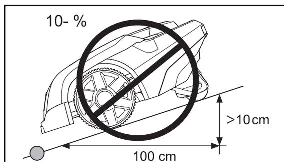
Se invece è presente un ostacolo non sensibile agli urti, ad esempio una staccionata o una siepe fitta, il cavo di limitazione può essere sistemato anche trasversalmente a una pendenza superiore al 10 %.
