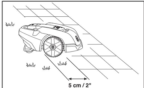
Se l'area di lavoro è suddivisa da un vialetto pavimentato uniforme che si trova al livello del prato, si può lasciare che Automower® lo attraversi. Può essere utile sistemare il cavo di limitazione sotto le piastrelle oppure nella fuga fra le piastrelle.
