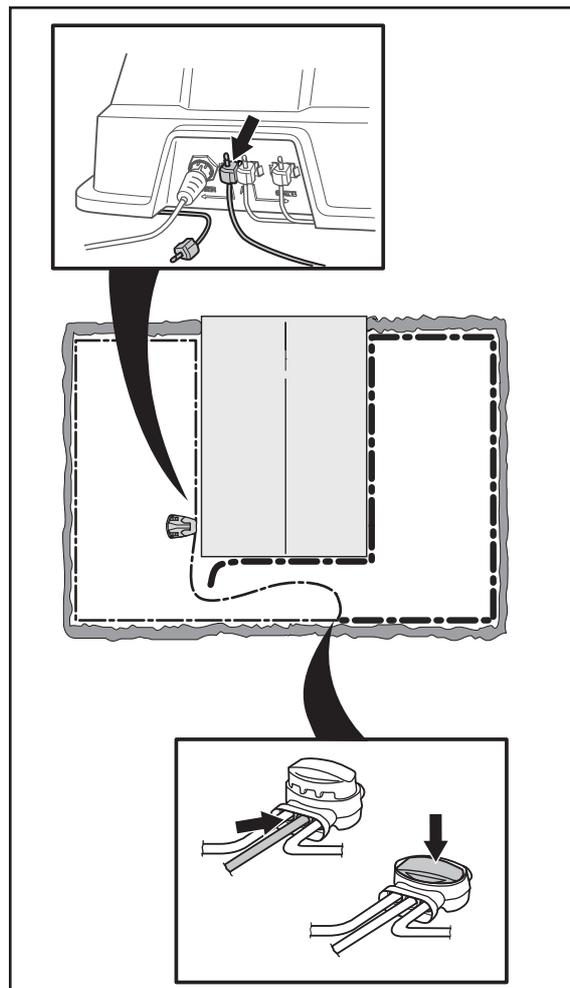
In tal caso, spostare il collegamento del nuovo cavo più vicino all'estremità scollegata (circa al centro della sezione di cavo sospetta) e verificare ancora una volta se la spia è verde o gialla lampeggiante.
