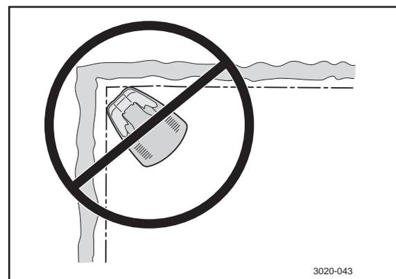
La stazione di ricarica deve essere posizionata su un terreno relativamente piano. Il lato anteriore della stazione di ricarica deve essere al massimo 3 cm più in alto del lato posteriore. Il lato anteriore della stazione di ricarica non deve mai essere più in basso del lato posteriore.
