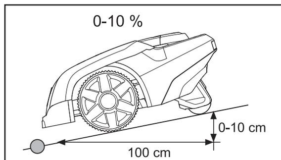
Non sistemare il cavo di limitazione trasversalmente a una pendenza superiore al 10 %, in quanto Automower® può avere difficoltà a girarsi. In tal caso, il rasaerba si ferma e visualizza il messaggio di guasto Fuori area di lavoro. Quanto detto vale soprattutto se il terreno è umido e sussiste il rischio di slittamento delle ruote.
