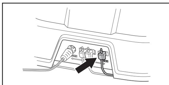
3. Fare uscire il cavo guida di almeno 2 metri dal bordo anteriore della piastra di ricarica.
