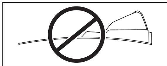
Se l'installazione viene effettuata in un'area di lavoro con pendenza ripida (per esempio attorno a una casa in collina), la stazione di ricarica deve essere posizionata in fondo al pendio. In questo modo è più semplice per il rasaerba seguire il cavo guida fino alla stazione di ricarica.
