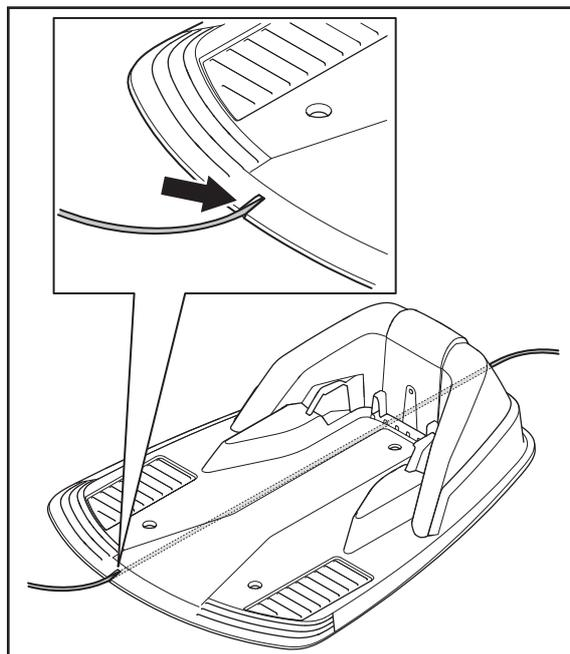
2. Montare il connettore sul cavo guida come già fatto per il cavo perimetrale, seguendo le istruzioni riportate nella sezione *3.5 Collegamento del cavo di limitazione*. Collegarlo al connettore di contatto sulla stazione di ricarica indicato con 'guide' (guida).
