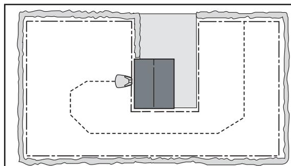
Quando la batteria è completamente carica, il rasaerba lascia la stazione di ricarica e inizia a tagliare in una direzione scelta casualmente nel settore di uscita da 90° a 270°.
