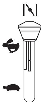
**(SE)** Vid kall motor: Skjut gasreglaget uppåt till ändläget "CHOKE" (↖).
