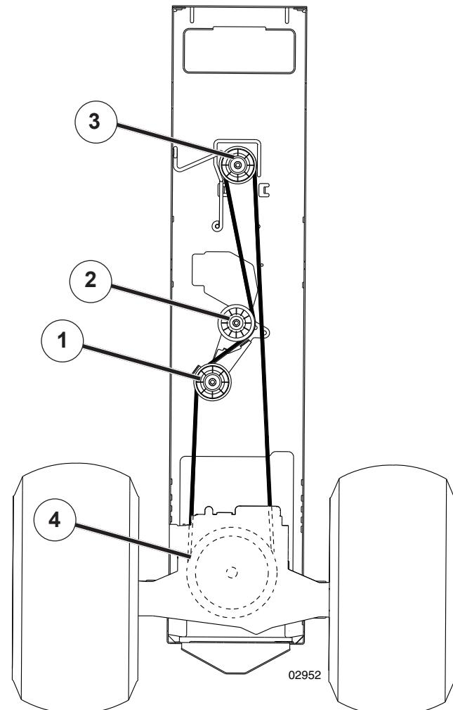
**SE** Montering sker i omvänt ordningsfölgd mot demontering. Kontrollera att remmen ligger innanför samtliga remstyrare. Använd enbart originalrem vid byte!
