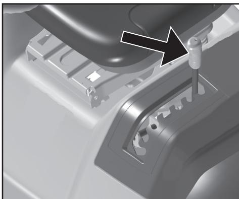
**(SE) 6. Snabb höjning/sänkning av klippaggregatet**
