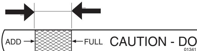
**SE** Oljenivået skall ligge mellom de to markeringene på pinnen. Hvis ikke skal motorolje SAE 30 påfylles til "FULL"-merket. Vinterstid (under frysepunktet) skal motorolje SAE 5W-30 anvandas.
