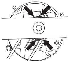
Monter la rondelle et visser correctement le boulon. Serrer le boulon au couple de 45-60 Nm.
