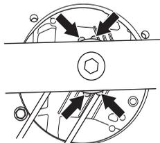
Monteer de ring en schroef de bout goed vast. De bout moet worden vastgezet met een moment van 45-60 Nm.
