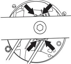
Montare la rondella e avvitare bene il bullone. Serrare il bullone con una coppia di 45-60 Nm.
