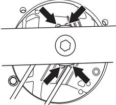
Scheibe anbringen und Bolzen gut festschrauben. Der Bolzen ist mit einem Moment von 45-60 Nm anzuziehen.
