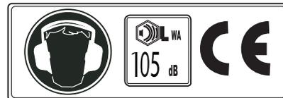
Livello di emissioni acustiche nell'ambiente conforme alle direttive dell'Unione Europea. Il livello delle emissioni della macchina è indicato nel capitolo DATI TECNICI e sulle decalcomanie. Solo macchine per il mercato europeo.
