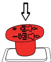
Quando il circuito di sicurezza ha arrestato la rotazione del gruppo di taglio, il comando deve essere premuto e tirato di nuovo per azionare le lame.
