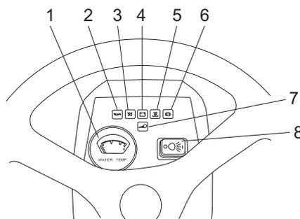
1 Indicatore di temperatura del liquido refrigerante. Il motore è raffreddato a liquido. Se viene indicato un surriscaldamento del motore, la prima cosa da fare è ridurre la temperatura del motore mantenendolo al minimo senza carico. Spegnere la trasmissione di potenza.
