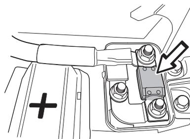
Un fusibile di alimentazione per la scatola di derivazione elettrica si trova su una staffa vicino alla batteria.
