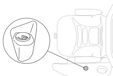
Riempire di gasolio. Non usare benzina in nessuna circostanza. Usare carburante con un numero di cetano superiore a 45. Miscela RME max 5% nei carburanti a base di olio minerale.
