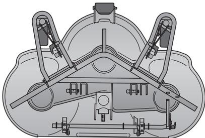
Il gruppo Combi, quando è montata la scocca BioClip, sminuzza l'erba prima di restituirla al prato come concime. Senza scocca BioClip, il gruppo utilizza il normale scarico posteriore. L'eiettore posteriore espelle i residui di falciatura dietro l'unità senza tritarli finemente.
