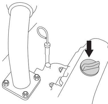
Avvitare l'astina accuratamente prima di accendere il motore. Accendere il motore e farlo funzionare al minimo per circa 30 secondi. Spegnerlo il motore. Attendere 30 secondi e controllare il livello dell'olio. All'occorrenza, rabboccare fino al segno FULL sull'astina.
