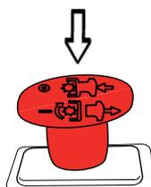
Controllare il livello del liquido refrigerante, rabboccare se necessario. Verificare inoltre che la griglia del radiatore e il radiatore stesso siano puliti e non otturati. La griglia si trova sul lato posteriore della macchina e sopra il cofano.
