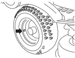
La pressione aria nella ruota pivotante del gruppo di taglio deve essere di 150 kPa/1,5 bar/22 psi.
