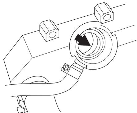
Una ripetuta mancanza di liquido refrigerante indica perdite. Il sistema di raffreddamento deve essere controllato da un professionista. Non è sufficiente rabboccare il liquido refrigerante. Se la temperatura del motore è troppo elevata, verrà perso il liquido refrigerante. Lasciare raffreddare il motore prima di rabboccare.
