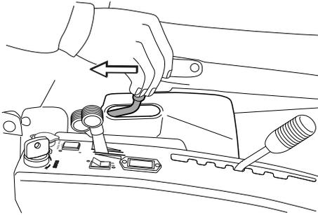
Se necessário fixar a unidade de corte com a alavanca mecânica de elevação.
