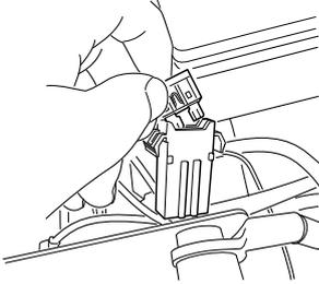
O fusível para a tomada eléctrica está localizado por baixo da ignição, atrás da placa lateral do painel de comandos. Tipo: Fusível chato, 7,5 A.
