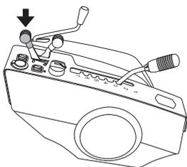
Para aumentar ou reduzir a rotação do motor puxar a alavanca para a frente ou para trás.
