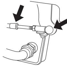
Premir o pedal algumas vezes, lubrificar novamente e voltar a colocar a protecção de borracha.
