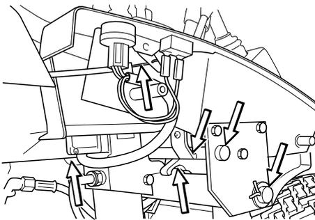
Voltar a montar a cobertura lateral do conjunto de alavancas.
