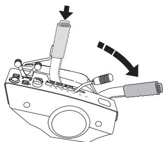
Descer totalmente a unidade de corte com a alavanca hidráulica de elevação caso a unidade de corte não desça completamente, ou as lâminas não rodarem. Manter a alavanca premida toda para a frente 0,5-1 segundos, para se assegurar que os cilindros hidráulicos estão na posição dianteira.
