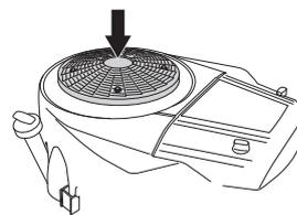
Verificar se o condutor de ar localizado no interior da cobertura do motor está limpo e não arranha a entrada de ar refrigerado.
