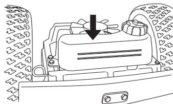
**R 422 Ts** Se necessário atestar com óleo de motor SAE 10W/40 (classe SF-CC).
