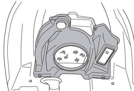
A refrigeração do motor é prejudicada, podendo resultar em danos ao motor se a grade da entrada do ar, condutor do ar ou entrada de ar refrigerado estão entupidas.
