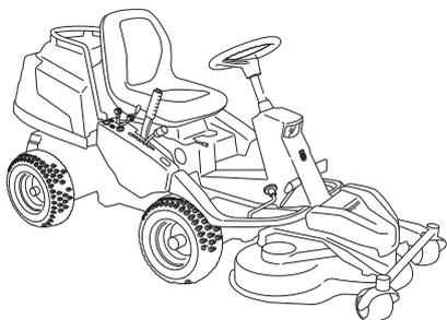
As máquinas estão equipadas com direcção-servo e equipamento de elevação hidráulico. A R 422 Ts AWD tem também tracção às quatro rodas.
