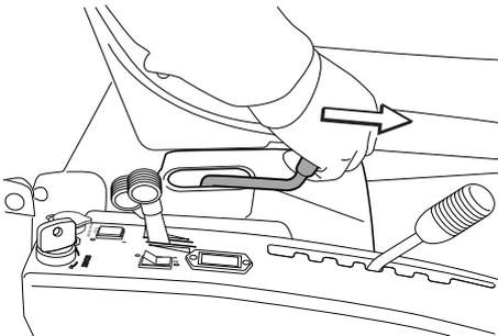
Manter a alavanca premida toda para a frente 0,5-1 segundos, para se assegurar que os cilindros hidráulicos estão na posição dianteira.
