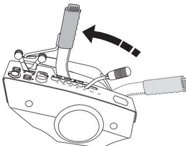
Se deixar a unidade de corte na posição inferior, o circuito de bloqueio da ignição irá evitar bloquear a ignição do motor.
