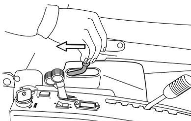
Se necessário, poderá então fixar a unidade na posição superior puxando para trás a alavanca mecânica de elevação até à posição de bloqueio.
