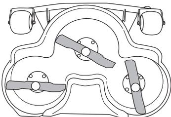
Caso as lâminas batam num objecto estranho, como uma pedra, devem ser inspeccionadas antes de serem usadas de novo.
