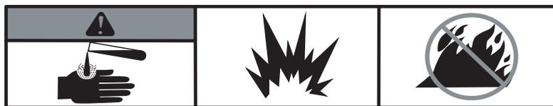
Аккумуляторная кислота - это коррозионная, взрывоопасная и легковоспламеняющаяся жидкость.
