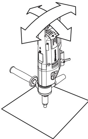
Se a parte de trás da máquina for inclinada para baixo, o LED verde central apaga-se e o LED vermelho da frente acende-se. Se a parte de trás da máquina for inclinada para cima, o LED vermelho da parte de trás acende-se.
