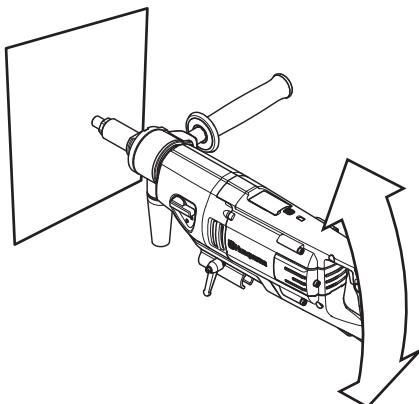
Se a parte de trás da máquina for inclinada para baixo, o LED verde central apaga-se e o LED vermelho da frente acende-se. Se a parte de trás da máquina for inclinada para cima, o LED vermelho da parte de trás acende-se.
