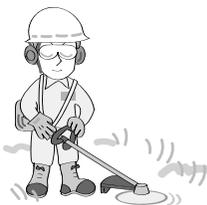
1. Afferrare le impugnature fermamente con entrambe le mani. Divaricare leggermente le gambe (poco più divaricate della larghezza delle spalle), in modo che il peso del corpo sia distribuito regolarmente su entrambe le gambe, e assicurarsi di mantenere una posizione stabile e regolare durante il lavoro.
