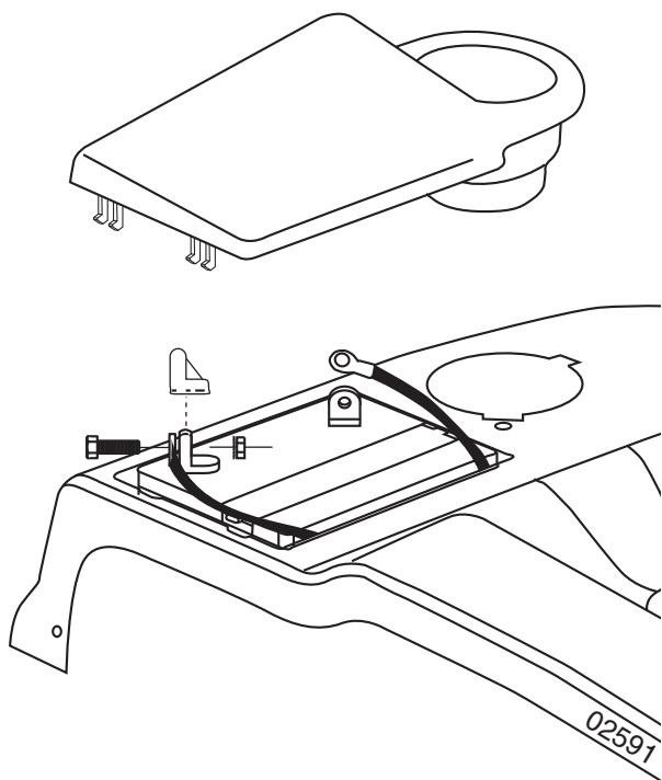
**(RU) ПРЕДУПРЕЖДЕНИЕ:** Для того, чтобы предупредить образование искр в результате случайного заземления, необходимо вначале подсоединить положительный полюс.
