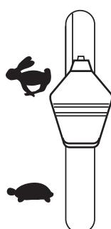
(RU) Разогретый двигатель: переместите регулятор газа на пол-пути в положение полного газа “充满了”.
