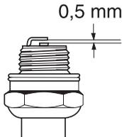
**N.B!** Usare candele originali o di tipo raccomandato! Altre candele possono danneggiare cilindro e pistone. Controllare che la candela sia munita di dispositivo di soppressione interferenze radio.
