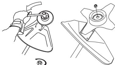
Il blocco di nylon del dado di bloccaggio non deve essere talmente usurato da poter essere girato a mano. Il blocco deve sopportare almeno 1,5 Nm. Quando è stato avvitato circa 10 volte, il dado va sostituito.
