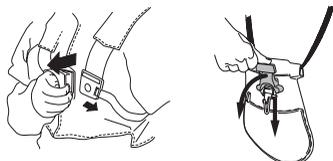
Controllare che le cinghie dell'imbracatura siano nella giusta posizione. Quando l'imbracatura e la macchina sono state regolate, controllare che il dispositivo di sgancio rapido funzioni.
