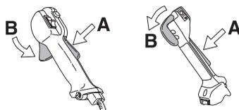
Controllare che l'acceleratore sia bloccato sul minimo quando il fermo è in posizione di riposo.
