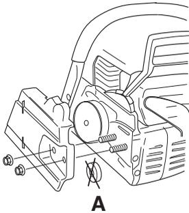
Montare la lama sui perni di fissaggio. Spingere la lama indietro al massimo. Sistemare la catena sopra la ruota motrice e farla passare nella scanalatura. Cominciare dalla parte superiore.
