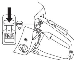
Arrestare il motore premendo il pulsante di arresto.
