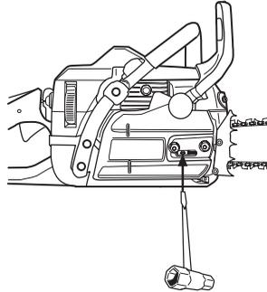
La tensione è corretta quando la catena rimane nella scanalatura intorno alla lama ed è possibile farla scorrere con le dita, senza sforzo. Serrare a fondo i dadi con la chiave combinata tenendo sollevata la punta della lama.
