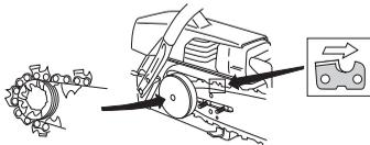
Controllare che il taglio dei denti sia rivolto in avanti, sul lato superiore della lama.
