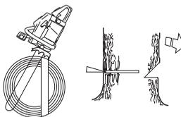
Il taglio di abbattimento deve finire parallelo alla linea del taglio direzionale, con una distanza tra i due di almeno 1/10 del diametro del tronco. La parte di tronco non tagliata è il fulcro.
