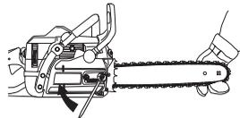
Controllare spesso la tensione di una nuova catena fino al termine del rodaggio. Eseguire il controllo regolarmente. Una catena correttamente tesa significa migliori caratteristiche di taglio e lunga durata.
