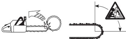
Il contraccolpo avviene sempre lungo il piano di taglio della lama. Di solito il movimento di motosega e lama è verso l'alto e verso l'operatore. Possono tuttavia verificarsi altre situazioni a seconda della posizione della motosega nel momento in cui il settore a rischio viene a contatto con un corpo estraneo.
