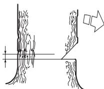
Inserire l'appoggio per la corteccia dietro il fulcro (se è stato montato l'apposito dispositivo). Lavorare a pieno gas e far avanzare la catena/lama lentamente nel tronco. Controllare che l'albero non si muova in direzione opposta a quella prevista per la caduta. Inserire un cuneo di abbattimento o un grimaldello non appena possibile.
