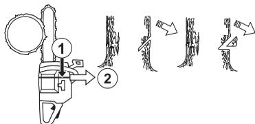
La profondità del taglio direzionale deve essere di 1/4 del diametro del tronco, con un angolo tra il taglio superiore e quello inferiore di almeno 45°.
