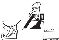
Accelerare al massimo e attivare il freno della catena girando il polso sinistro verso la protezione antictraccolpo. Non lasciare l'impugnatura anteriore. **La catena deve bloccarsi immediatamente.**
