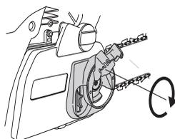
Controllare spesso la tensione di una nuova catena fino al termine del rodaggio. Eseguire il controllo regolarmente. Una catena correttamente tesa significa migliori caratteristiche di taglio e lunga durata.
