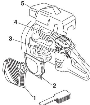
Pulire il sistema di raffreddamento con una spazzola una volta la settimana, più spesso se necessario. Se il sistema di raffreddamento è sporco o ostruito provoca il surriscaldamento della macchina, con conseguenti danni a cilindro e pistone.
