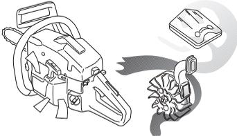
**IMPORTANTE!** Per mantenere sempre un livello ottimale di funzionamento della depurazione centrifuga, il sistema va pulito agli intervalli indicati. Pulire la presa dell'aria sul dispositivo di avviamento, le alette del volano, lo spazio intorno al volano, il condotto di aspirazione e il vano del carburatore.
