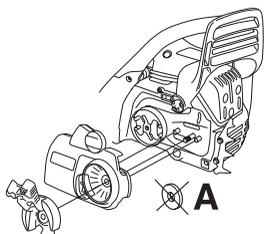
Montare la lama sui perni di fissaggio. Spingere la lama indietro al massimo. Sistemare la catena sopra la ruota motrice e farla passare nella scanalatura. Cominciare dalla parte superiore.
