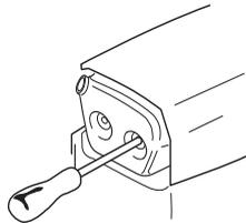
Alcune marmitte sono dotate di una speciale retina parascintille. Se la macchina è dotata di una marmitta di questo tipo, è consigliabile pulire la retina una volta alla settimana. Per un risultato ottimale usare una spazzola di acciaio. Una rete intasata comporta surriscaldamento del motore con conseguenti danni allo stesso.
