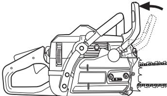
Svitare i dadi della lama, togliendo anche il coperchio della frizione (freno della catena). Eliminare la protezione per il trasporto (A).
