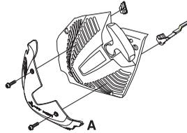
Questo riduce il volume dell'aria di raffreddamento e impedisce l'aspirazione di grosse quantità di neve nella sede del carburatore.
