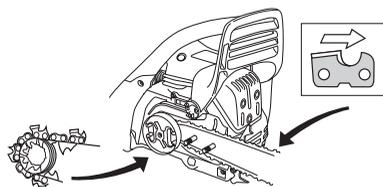
Controllare che il taglio dei denti sia rivolto in avanti, sul lato superiore della lama.
