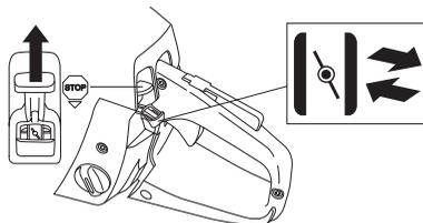
**Gas di avviamento:** Si ottiene automaticamente spostando il comando come indicato precedentemente.
